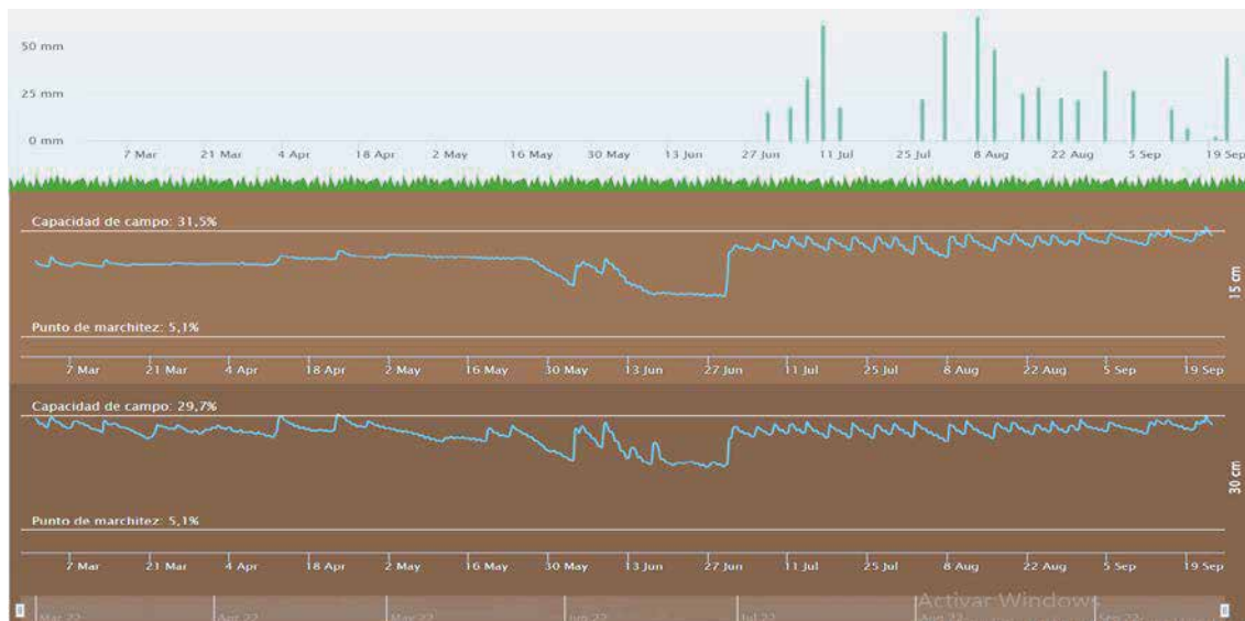
Figura 13. Perfil de humedad del suelo a dos profundidades en una parcela de Aimcra (Valladolid) con cultivo de remolacha en ciclo de primavera.
